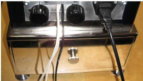
Durchlichtbeleuchtung in Schubfach montiert, leicht zugänglich über Geräterückwand
